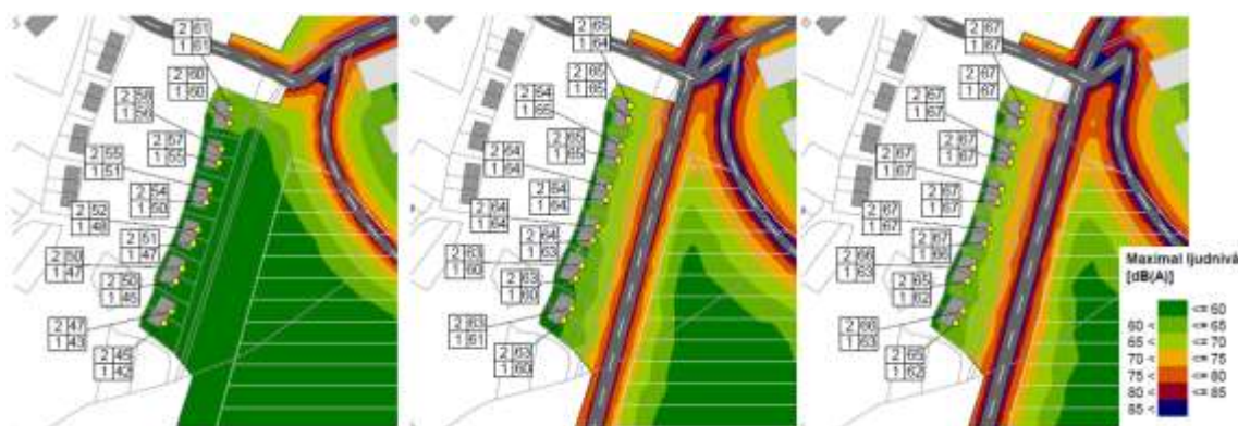
Utdrag från bullerutbredningskarta för del av Västra vägen med maximal ljudnivå, från vänster över; skede 1, skede 2 och skede 3.
