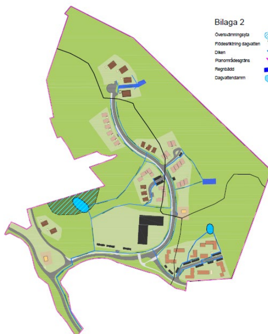
Principskiss över lösningsförslagets utformning samt viktiga släpp (Dagvattenutredning - bilaga 2, 2023).
