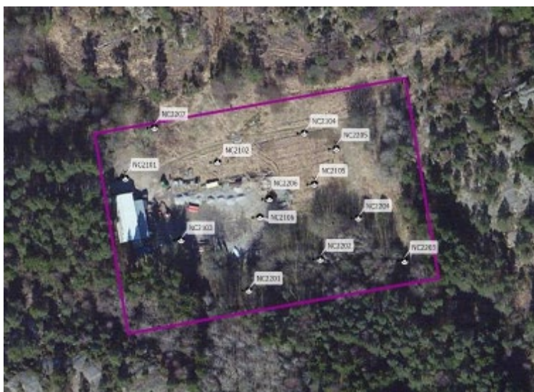
Markerade provpunkter för markundersökningen (Miljöteknisk markundersökning (2022)).
