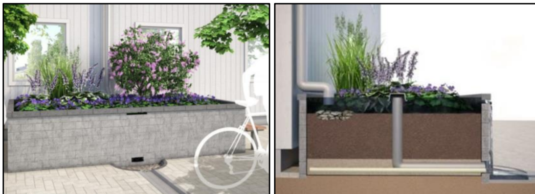
Figur 5-5. Exempel på upphöjd växtbädd som tar emot dagvatten från tak via stuprör (Vinnova, 2014).
