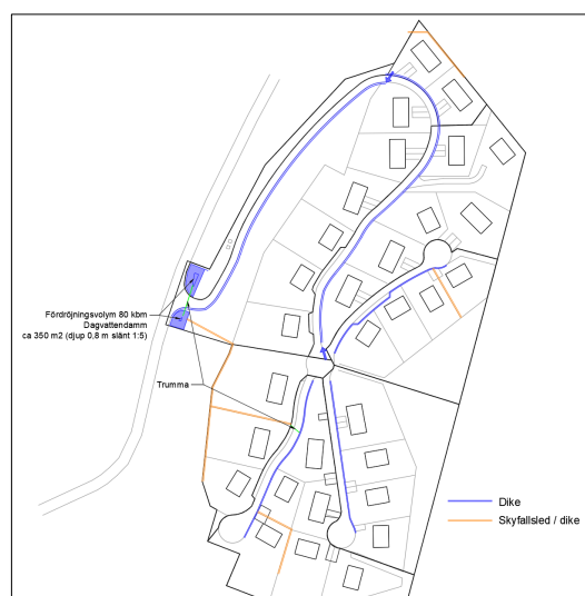
Figur 13. Dagvattenlösning för planförslaget.
