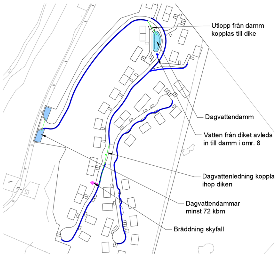
Figur 1 Helhetsbild över föreslagna åtgärder. Diken och skyfallsleder leder hela planområdets dagvatten till öppna dammar vid Bräckevägen
